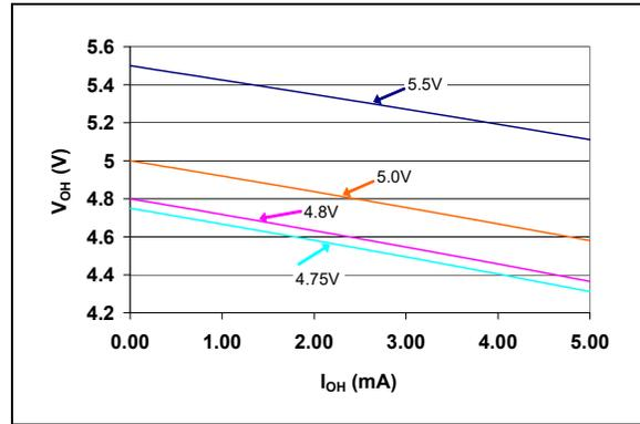
**FIGURE 2-22:**  $V_{OH}$  vs.  $I_{OH}$
