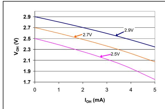
**FIGURE 2-23:**  $V_{OH}$  vs.  $I_{OH}$
