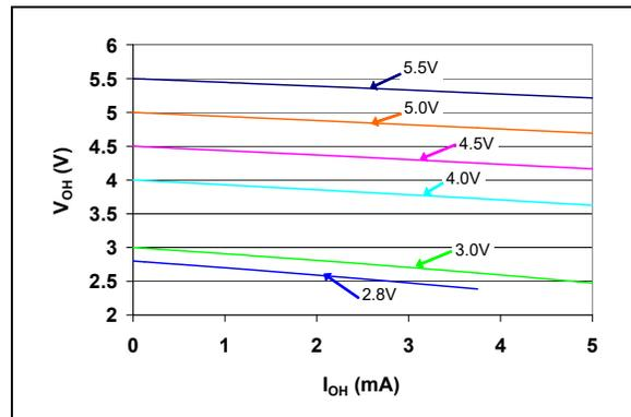
**FIGURE 2-24:**  $V_{OH}$  vs.  $I_{OH}$
