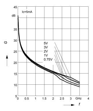
Power Gain  $G_{ma}$ ,  $G_{ms} = f(V_{CE})$ : ——  $|S_{21}|^2 = f(V_{CE})$ : - - - -
