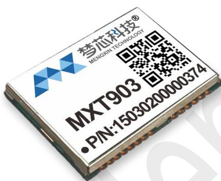
图 1-1 MXT903 BDS/GPS 双系统亚米级导航定位模块
