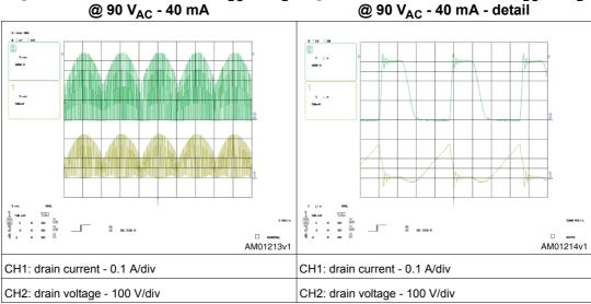
Figure 16. EVL6562A-35WFLB V<sub>DS</sub> and I<sub>D</sub> Figure 17. EVL6562A-35WFLB V<sub>DS</sub> and I<sub>D</sub>
