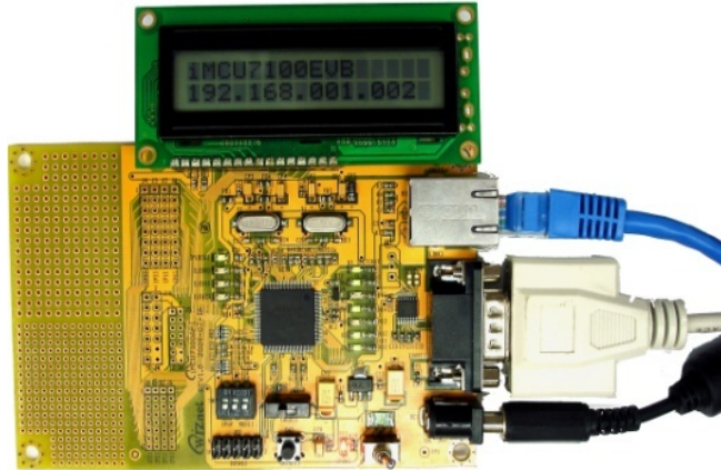
<Fig.2.1> iMCU7100EVB 케이블 및 LCD 연결
