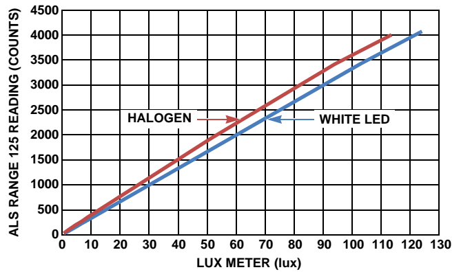
FIGURE 7. ALS TRANSFER FUNCTION 2 LIGHT SOURCES (125 LUX RANGE)
