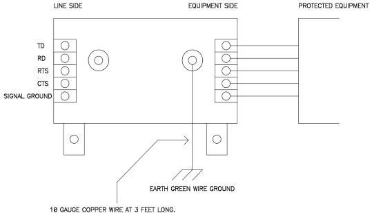
10 GAUGE COPPER WIRE AT 3 FEET LONG OR BRAIDED CABLE MADE SPECIFICALLY FOR GROUNDING PURPOSES.
