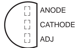
LM336-2.5, LM336B-2.5 . . . LP PACKAGE (TOP VIEW)
