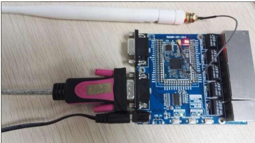
3. 短按“退出透传/恢复出厂值”ES0 按钮，打开配置软件，选择串口号，点击搜索模块，在命令执行与回复框里有>:at (:Found Device at COM7(115200)!消息出现，点查询配置，后读取模块当前参数，说明模块在正常。
