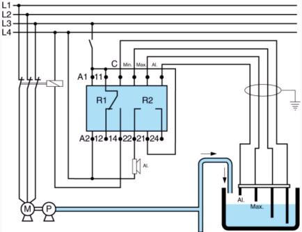
Note: Dans le cas où le réservoir est conducteur (métal), il peut être utilisé comme électrode de référence (C). Une LED verte visualise l'alimentation. Une LED jaune visualise l'état du relais de sortie. Une LED rouge visualise, l'état du relais d'alarme.
