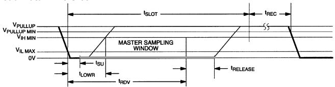
$60 \mu s \le t_{SLOT} < 120 \mu s$   $1 \mu s \le t_{LOWR} < 15 \mu s$   $0 \le t_{RELEASE} < 45 \mu s$   $1 \mu s \le t_{REC} < \infty$   $t_{RDV} = 15 \mu s$   $t_{SU} < 1 \mu s$
